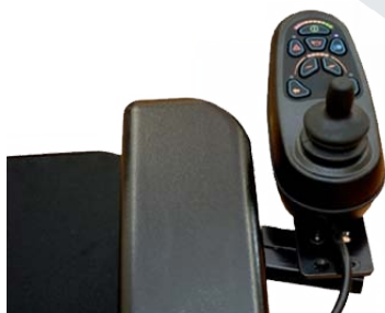
Cuadro de control auxiliar
